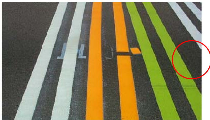
شکل ۹-۲: نحوه قرارگیری صفحه مخصوص اندازه‌گیری ضخامت فیلم رنگ در خط‌کشی [۱۱]
