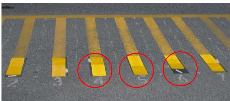
شکل ۹-۵: اجرای خط‌کشی توسط ماشین خط‌کش روی صفحه [۱۱]
