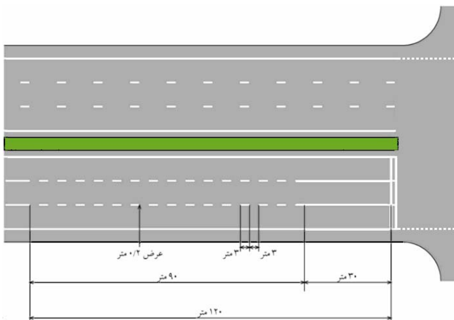
شکل ۸-۵۷: خطوط هشدار در تقاطع‌های هم‌سطح بزرگراهها [۵]
