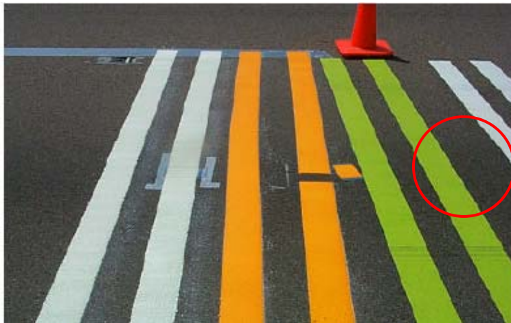
شکل ۳-۵: قرارگیری صفحه مخصوص اندازه‌گیری ضخامت فیلم رنگ در اجرای خط‌کشی [۱۶]
