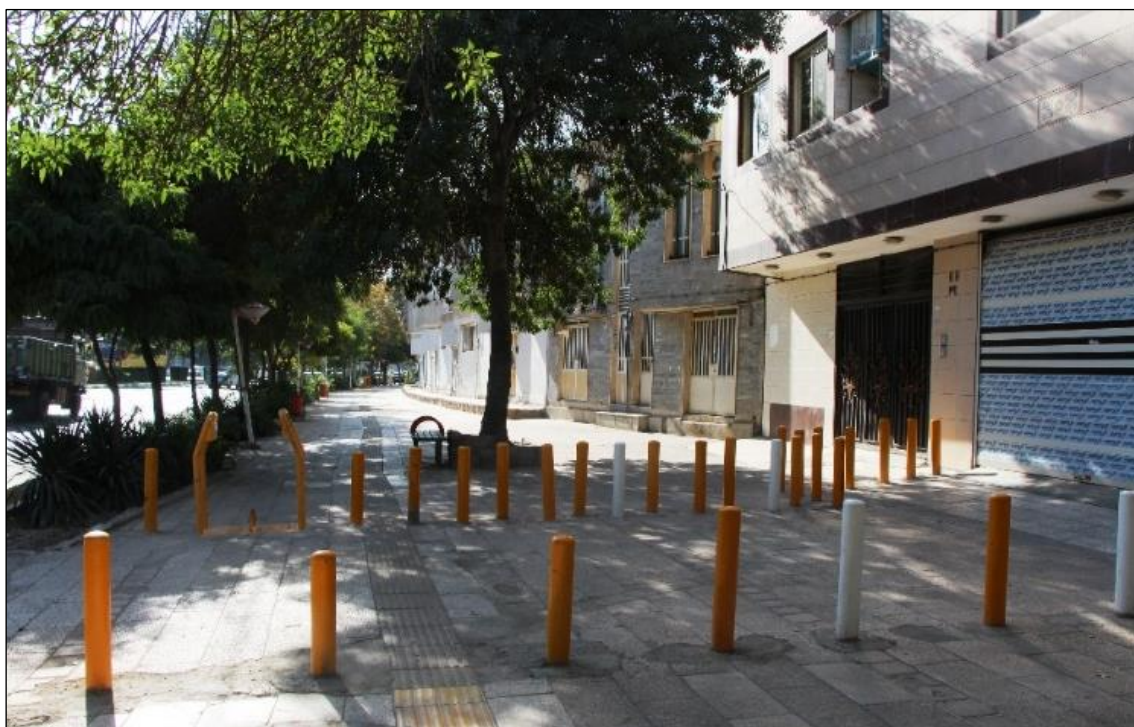
شکل ۷-۱- استفاده از استوانه ثابت برای جلوگیری از ورود و پارک غیر مجاز
