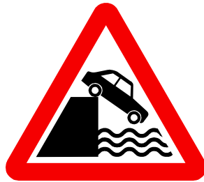
شکل ۳-۴۵ - خطر سقوط در آب
