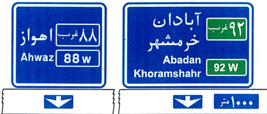
شکل ۶-۵- نوع آویز علامت پیش‌آگاهی جهت‌نمای مقدماتی (Forward) که مقصدهای خطوط حرکت را در یک آزادراه مشخص می‌کند.
