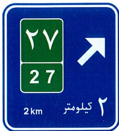
شکل ۶-۱- علامت پیش‌آگاهی جهت‌نمای مقدماتی (Forward) در یک آزادراه
