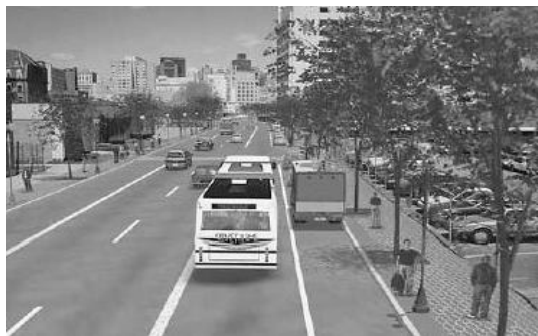
شکل (۴-۲): خط ویژه داخلی همسو با جریان در بوستون، ایالات متحده
