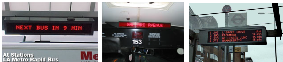
شکل (۲-۲۸): نمونه ای از کاربرد تابلوهای پیام متغیر جهت اطلاع رسانی به مسافران
