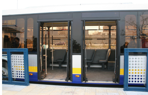
شکل (۲-۱۹): نحوه قرارگیری درهای وسیله‌نقلیه مورد استفاده در شهر پکن، چین
